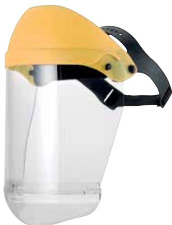
Fascia frontale in spugna tergisudore intercambiabile, banda superiore per la regolazione dell'altezza della calotta, regolazione di circonferenza cranica tramite fascia elastica, schermo in policarbonato spessore 1 mm ribaltabile di 90°, può essere indossata sopra ad occhiali protettivi e respiratori, mentoniera in policarbonato sostituibile, certificato al punto 3 della EN166 per protezione da schizzi di liquidi, resistente ad impatti.
