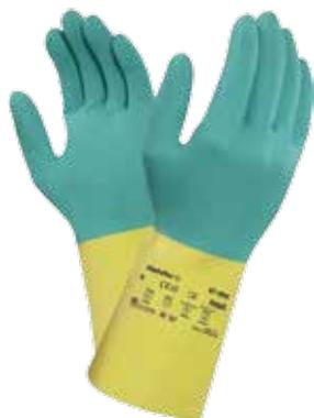
Guanto in lattice naturale con miscela di Neoprene per maneggio di sostanze chimiche, spessore 0.68 mm, interno felpato in puro cotone, trattamento "Sanitized Actifresh", finitura esterna in rilievo a rombi, con ottima presa asciutta e bagnata, doppia protezione, lunghezza 323 mm.
